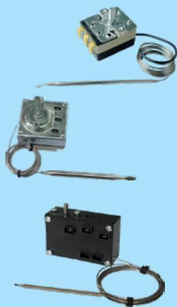
I termostati a capillare sono soggetti a deriva a causa delle variazioni di temperatura sul capillare e sul soffietto. Il differenziale dei termostati a lampada e a capillare non è solitamente regolabile ed è pari a circa il 2.5% dell'intervallo di temperatura. Sono disponibili in versione unipolare o tripolare.
